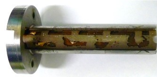
金属3Dプリンタで作製した部品のサビ
