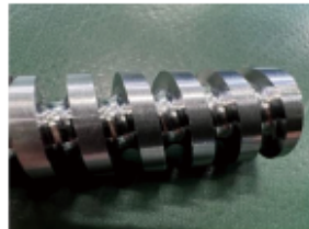
切削加工で製作した滑らかな水管表面
