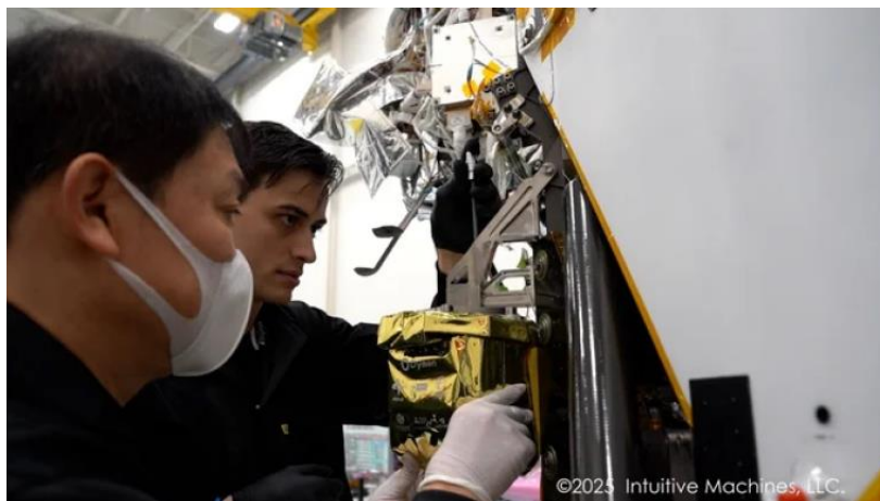
ダイモンと Intuitive Machines 社による月面探査車 YAOKI と月着陸船 Nova-C への最終統合
