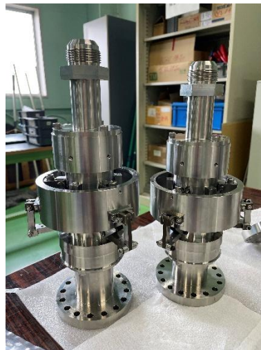
当社が加工した金属部品「クイックディスコネクト」 ロケット機体と燃料注入ホースをつなぐ重要な部品
